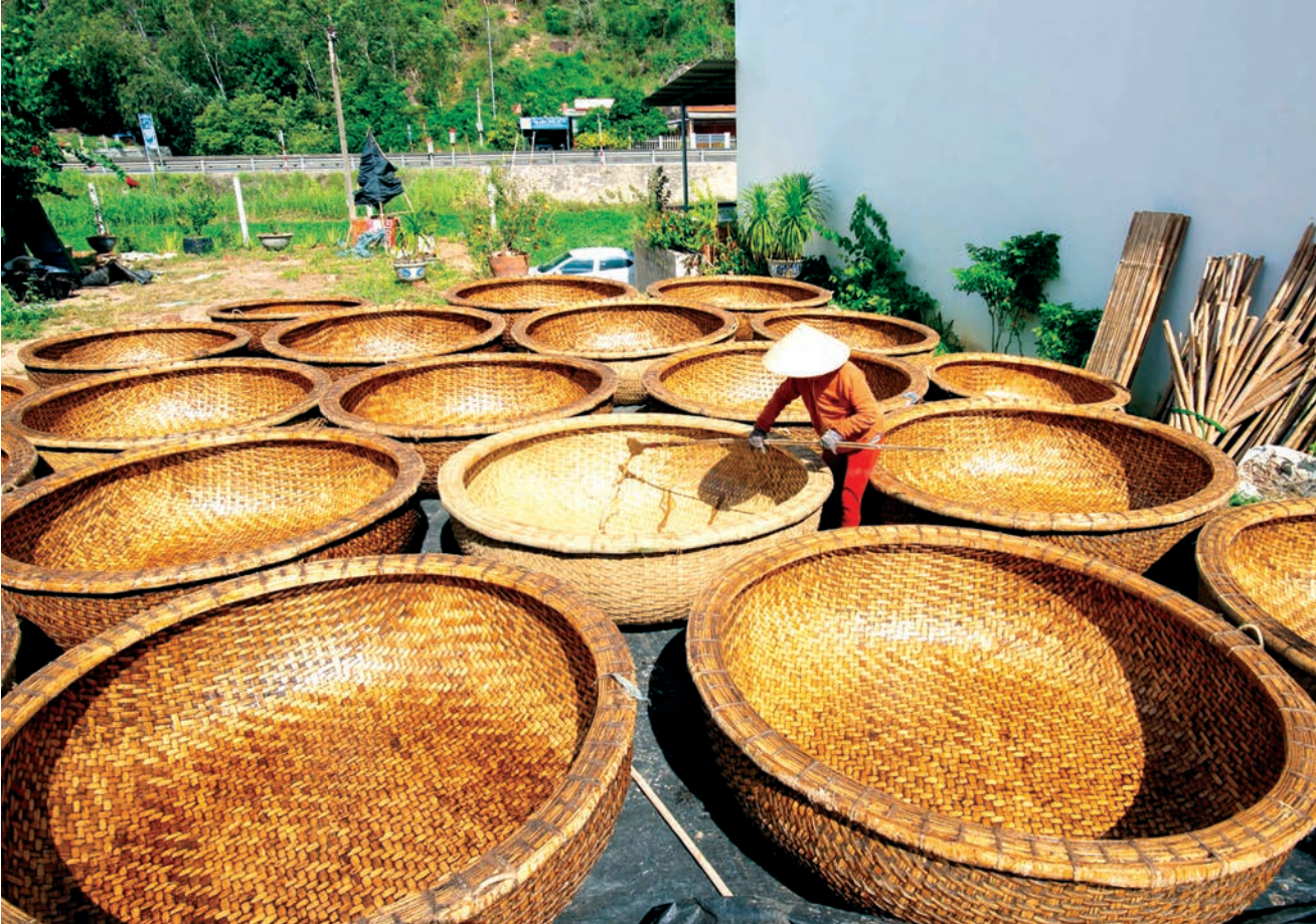
Kỹ thuật chống thấm bằng phân bò và nhựa dầu rải được truyền lại từ đời cha ông, giúp thúng có màu đẹp chống mối mọt. Lớp chống thấm đặc biệt này có thể dùng trong môi trường nước biển 4 - 5 năm. Thúng bị rách có thể được đem về và lại. Ảnh: NGUYỄN TRÌNH
