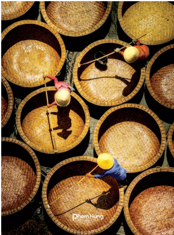
Quét dầu rải - một công đoạn trong quá trình sản xuất thuyền thúng truyền thống. Ảnh: PHẠM HƯNG
