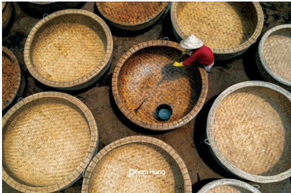
Làm ra chiếc thúng chai, một người thợ phải trải qua nhiều công đoạn gồm: chẻ tre, vót tre, đan mên, lện, nức và quét dầu. Ảnh: PHẠM HƯNG
