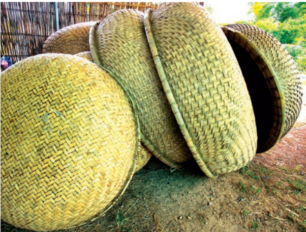
Khi thúng đã hoàn thiện, người thợ sẽ dùng phân bò tươi hòa nước trát đều lên hai mặt. Cách làm này nhằm bịt kín các kẽ hở của nan tre. Hai lớp phân bò khô lại tiếp tục quét hai lớp nhựa dầu rải là hoàn thành. Ảnh: NGUYỄN TRÌNH
