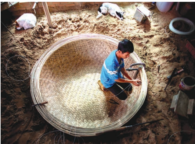
Khâu then chốt là làm mên thúng (đáy thúng), tre được vót mỏng và đan đều khít với nhau. Ảnh: NGUYỄN TRÌNH
